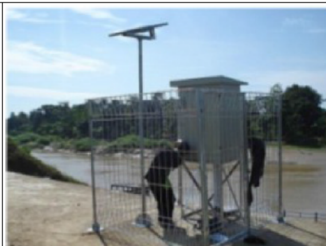
Stasiun Kualitas dan Tinggi Muka Air Cabang Bungin, Telemetri Pengembangan FEWS, Dit PSDA, 2013
